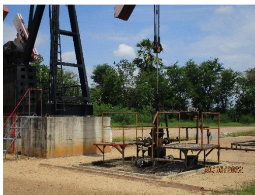
รูปที่ 2-11 คันคอนกรีตล้อมรอบหัวหลุมผลิต
