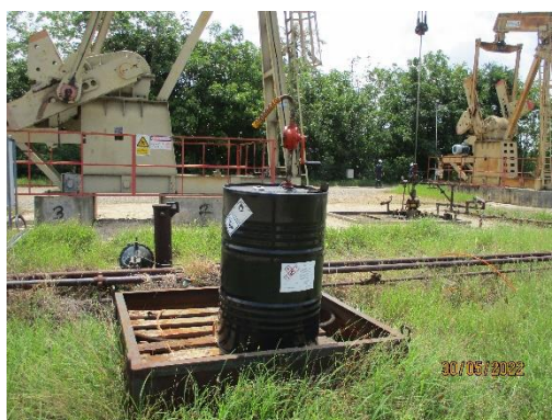
รูปที่ 2-14 การจัดวางถังสารเคมีบนถาดรอง
